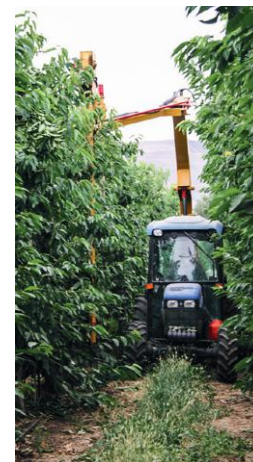
Figura 4: La poda mecánica del sistema UFO de paredes verticales es 13 veces más rápida que la poda manual.
