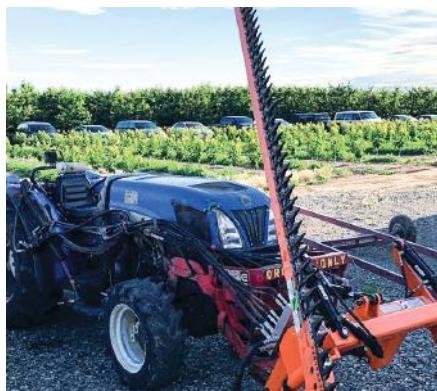
En la foto se puede ver un implemento de barra única, que se ha vuelto muy popular porque es más barato que la maquinaria que vimos antes, pero, además, que tiende a ser más estable, por lo que se logra un poco más de uniformidad.
