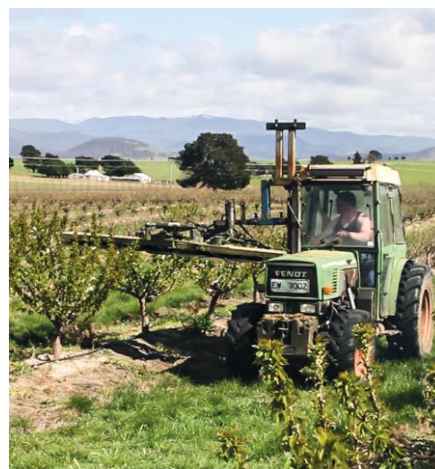
Figura 4: La poda mecánica del sistema UFO de paredes verticales es 13 veces más rápida que la poda manual.
